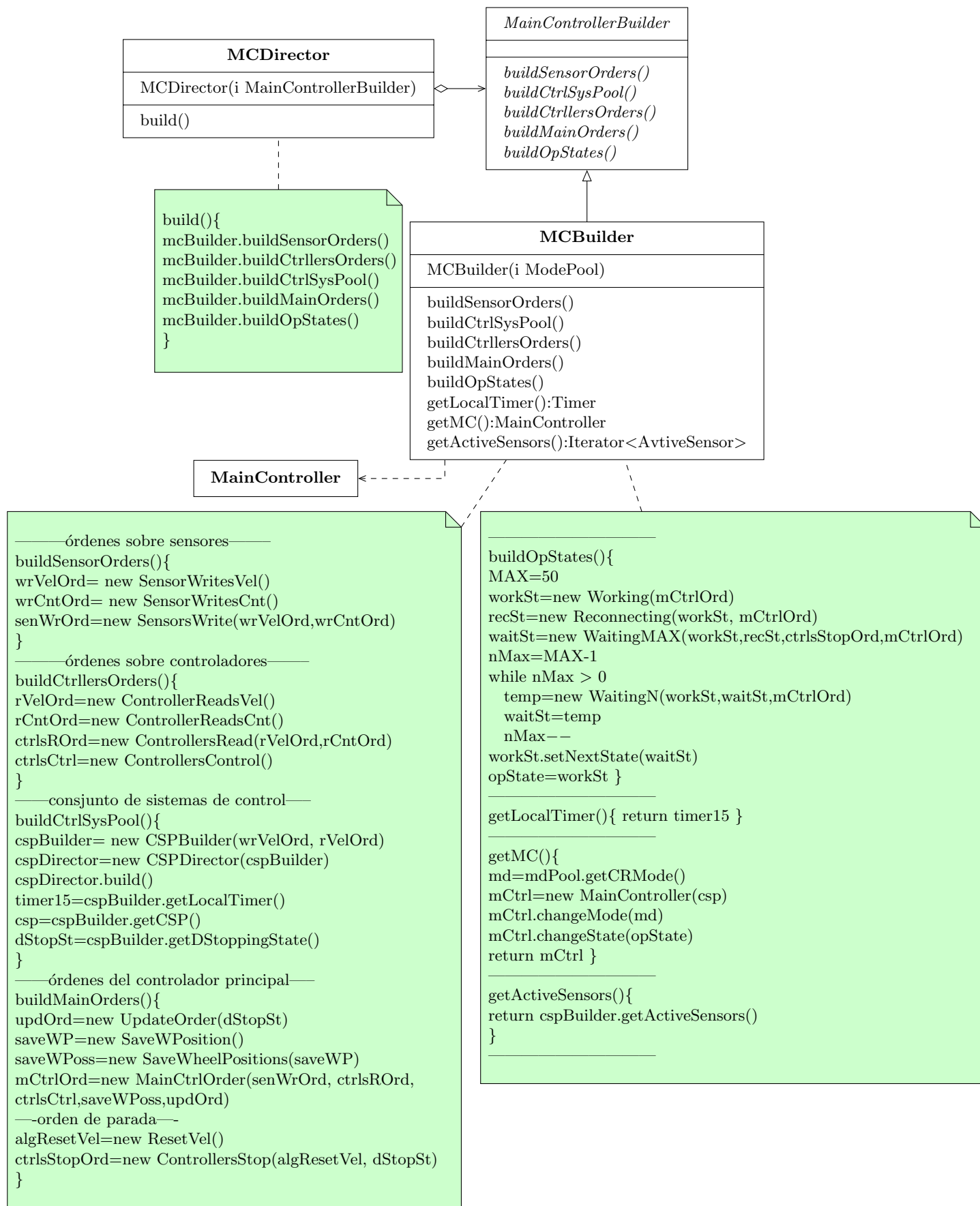
Figura 5.45: Constructor de sistema de control principal. Patrón Constructor. Ver también Figura 5.46 MCDirector MainControllerBuilder MCBUILDER
