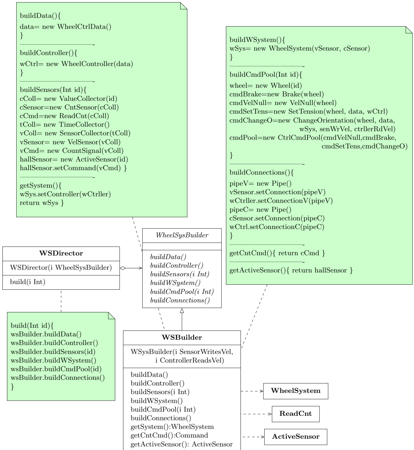
Figura 5.42: Constructor de sistema de control de ruedas. Patrón Constructor. Ver también Figura 5.46 WSDirector WheelSysBuilder WSBuilder
